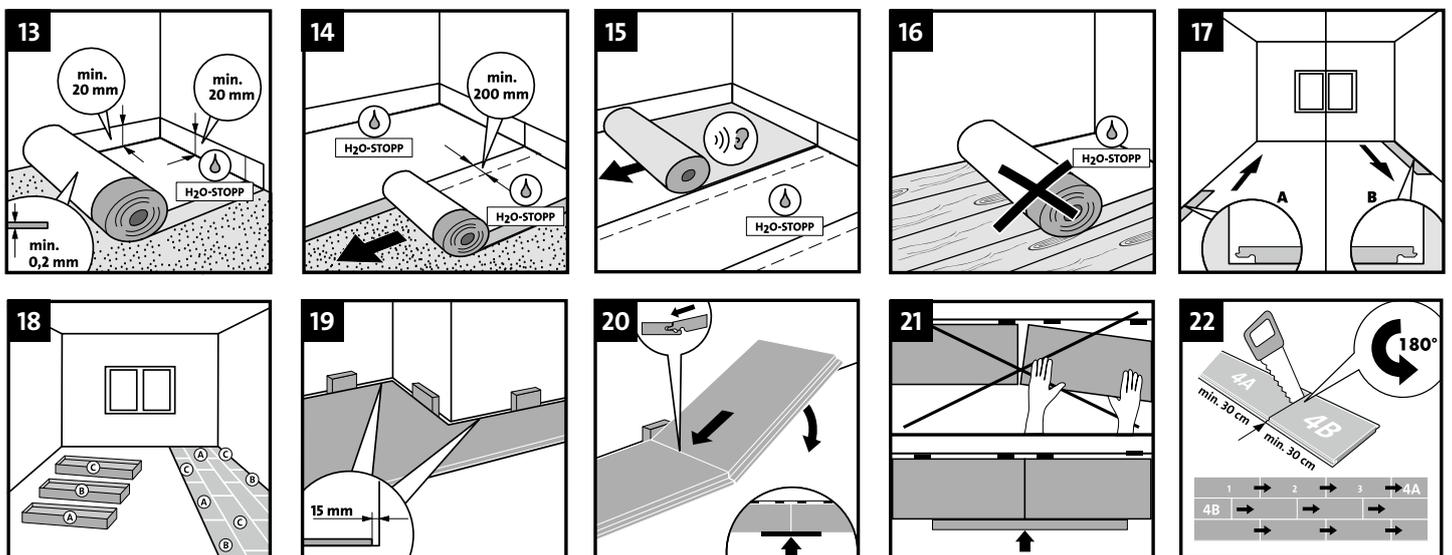
13. min. 20 mm, min. 20 mm, H<sub>2</sub>O-STOPP, min. 0,2 mm
